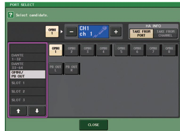
Ceci affecte le signal de sortie du périphérique AXT400 au canal d'entrée mais vous permet en même temps de commander et de surveiller le niveau de signal de l'AXT400 provenant du canal d'entrée.
