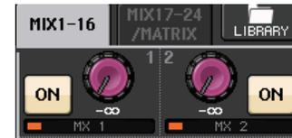
Le bouton TO MIX SEND LEVEL s'affiche sous une couleur identique à celle du bouton correspondant dans la section SELECTED CHANNEL. Dans ce cas, vous pourrez utiliser le bouton correspondant de la section SELECTED CHANNEL pour régler le niveau d'envoi.
