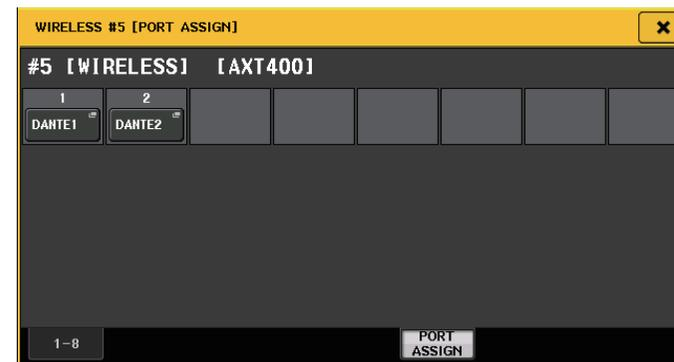
Exemple : Connexion de la sortie d'un système Shure AXT400 vers la prise OMNI 1 sur une console CL et affectation du signal au canal d'entrée 1.
