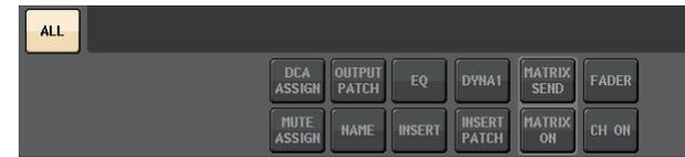
Si vous activez la fonction Recall Safe pour les paramètres globaux, les touches de sélection des paramètres de rappel sécurisé pour le canal sélectionné s'allument en vert, comme suit.
