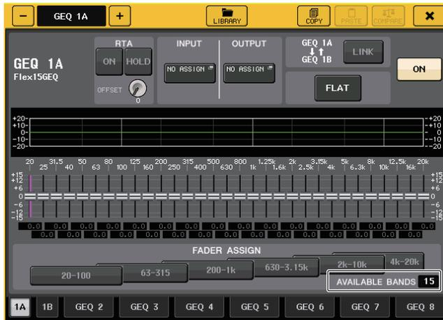
Cette fenêtre est identique à celle du 31BandGEQ, hormis le fait que la zone de paramètre AVAILABLE BANDS (Bandes disponibles) indique le nombre en temps réel de bandes supplémentaires (15 au maximum) pouvant être contrôlées dans le GEQ actuellement sélectionné.
