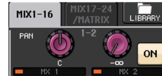
Vous pouvez lier les principaux paramètres de deux paires de bus MIX/MATRIX pair/impair adjacents. Si le bus MIX/MATRIX de destination de l'envoi est affecté en stéréo, le bouton gauche des deux boutons adjacents TO MIX SEND LEVEL et TO MATRIX SEND LEVEL (Niveau d'envoi vers MATRIX) fera office de bouton TO MIX PAN (Panoramique vers MIX) ou TO MATRIX PAN (Panoramique vers MATRIX). (Si le mode BALANCE est sélectionné dans la fenêtre TO STEREO/MONO, le bouton fonctionnera comme un bouton BALANCE.)
